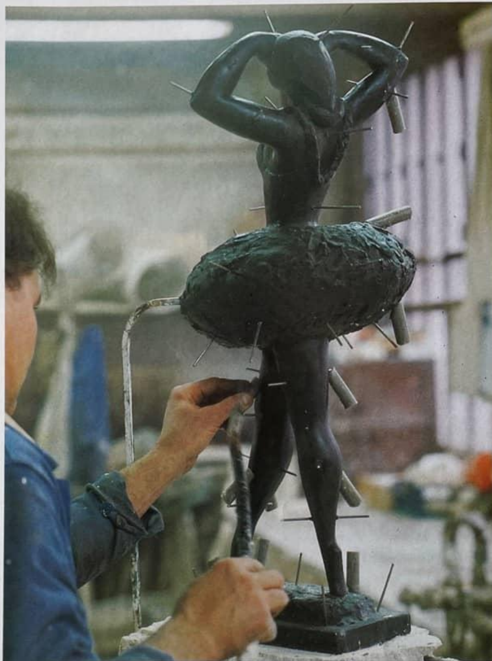
Attaque de jets de coulée sur une cire d'Orloff.
