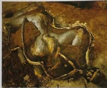
Aspect d'une fonte au sable après cassage du moule.
