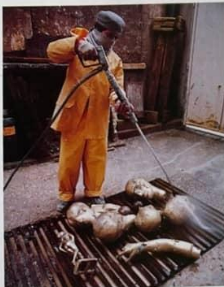
Dérochage des fontes ébarbées, à l'eau chaude sous pression.
