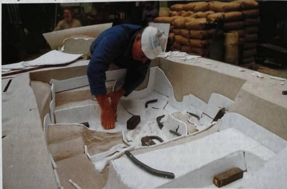
Moulage au sable synthétique : construction du noyau.
