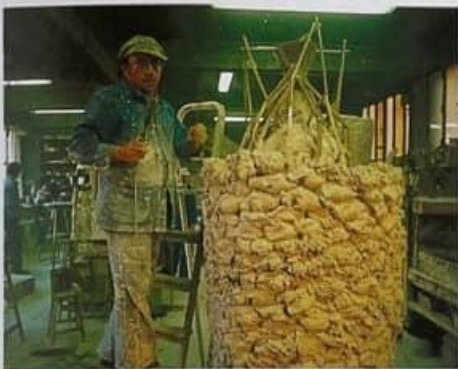
Construction d'un moule en cire perdue en réfractaire. On voit encore les jets de coulée avant l'enrobage définitif.
